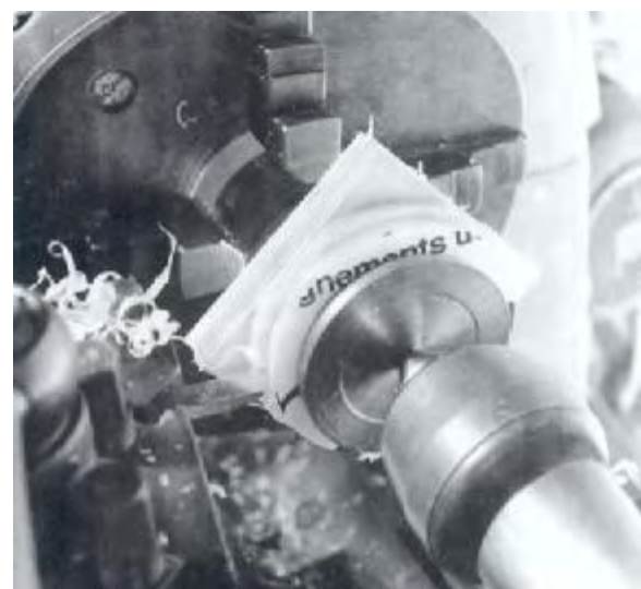
Рисунок 30 - Формирование дисков из стопки болванок между патроном и задней бабкой
