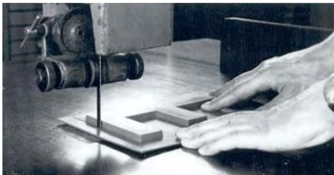
Рисунок 7 – Обрезка края при помощи ленточной пилы
