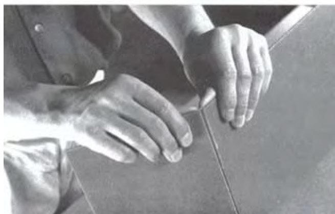
Рисунок 11 - Нанесение бороздки и поломка
