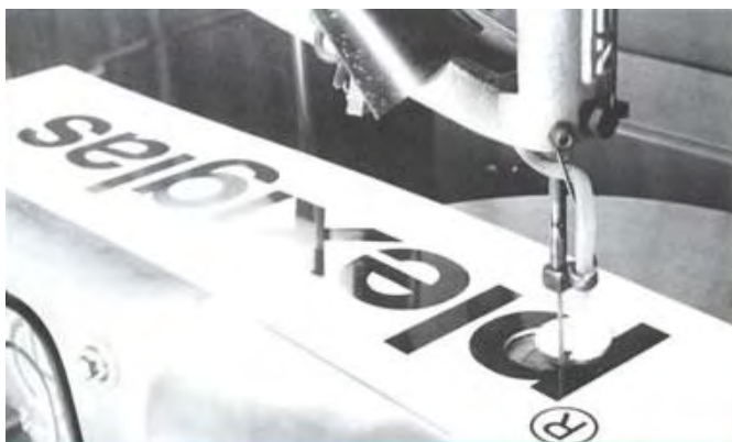
Рисунок 9 - Выпиливание лобзиком логотипа PLEXIGLAS
