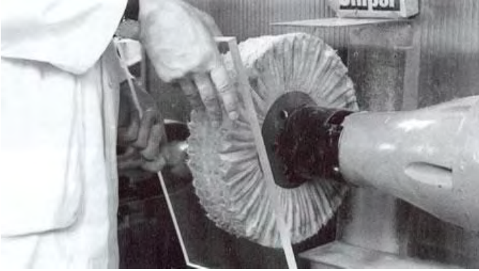
Рисунок 40 - Полировка матерчатым полировальным кругом
