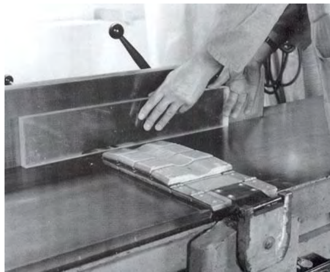
Рисунок 36 - Сглаживание торца на продольно - строгальном станке
